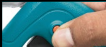
Interruptor de seguridad
