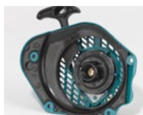
Arranque fácil: un muelle en la polea de arranque nos ayuda para facilitarnos la puesta en marcha.
