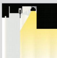
Iluminación bañado de pared
